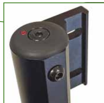
Sistema anti sfarfallamento ruote anteriori
