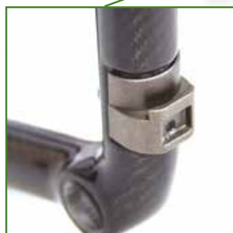
Alloggiamento regolazioni dell'inclinazione delle forcelle integrato
