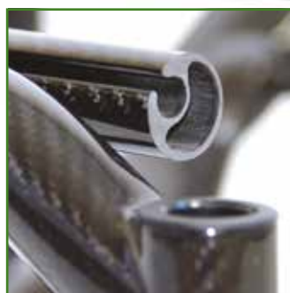
Tubi seduta in carbonio integrati nel telaio
