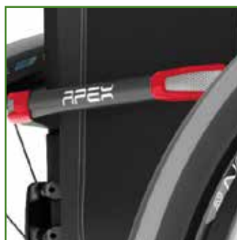
Barra d'irrigidimento in carbonio con catarifrangenti
